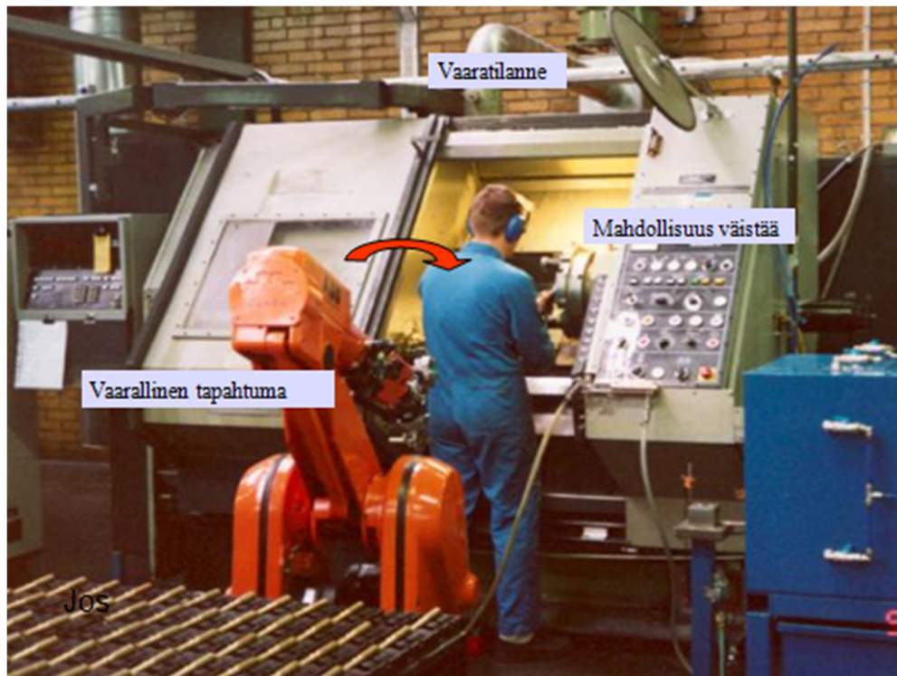
Kuva 2 Robottiyksikössä vanha sorvi on varustettu työkappaleen syöttölaitteena toimivalla teollisuusrobotilla.
